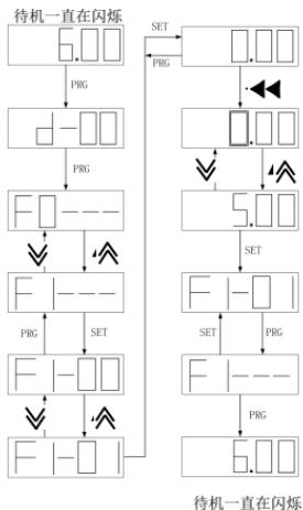
图 3-1 修改功能参数流程图
