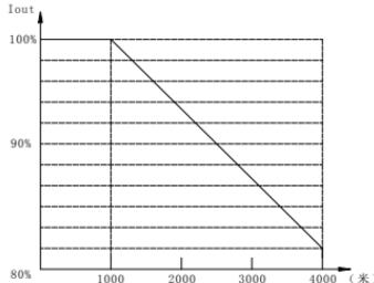
图 1- 1 变频器额定输出电流与海拔高度降额使用关系
