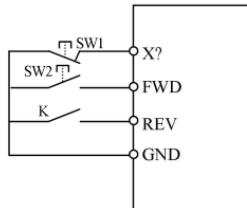
b) 三线控制模式 2 接线图
