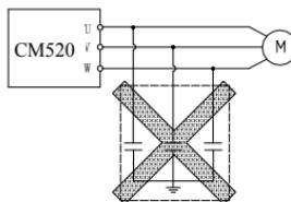
图 1-1 变频器输出端禁用电容器示意图
