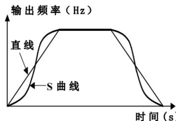
图 2 变频器的加、减速曲线
