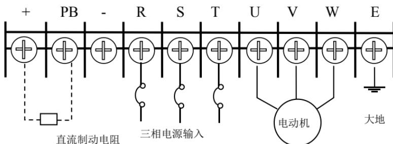
图 2-4 主回路端子台配线图
